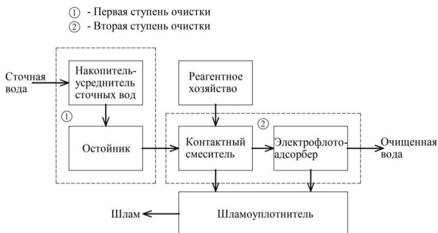
Рис. 2. Технологическая блок-схема поэтапной очистки СВ, образующихся на ТФ
