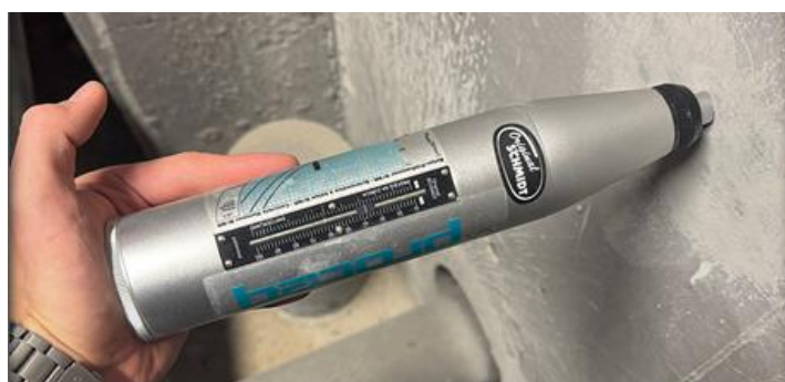
Рис. 2. Измерение прочности бетона молотком Шмидта
