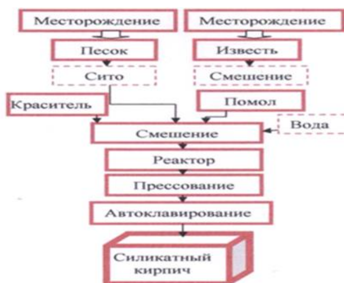
Рис. 1. Блок-схема производства силикатного кирпича [6]
