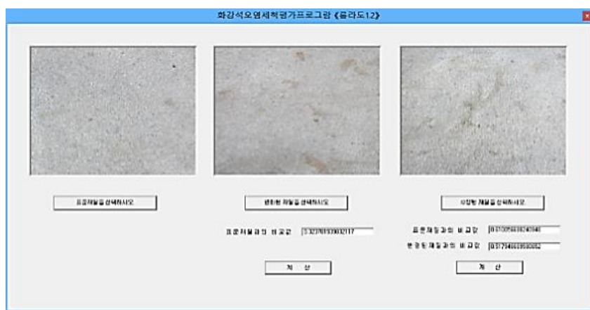
Рис. 3. Интерфейс оценки эффективности очистки поверхности гранита, загрязненного древесным соком
