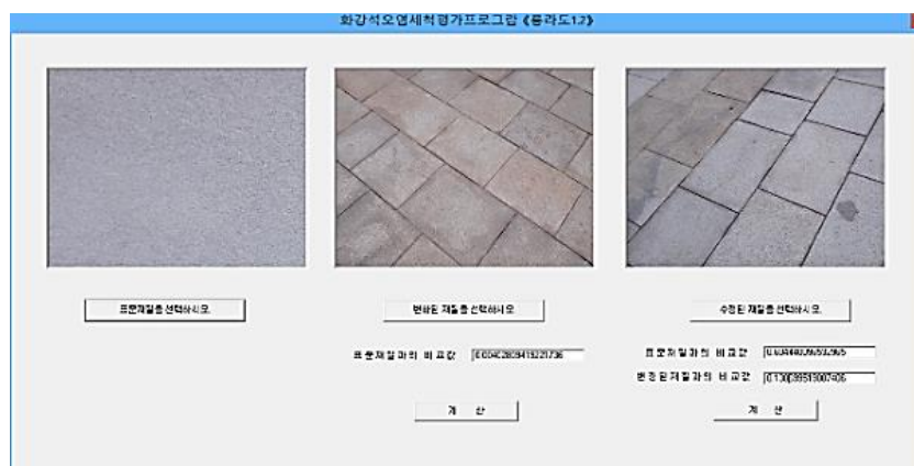
Рис. 5. Интерфейс оценки эффективности очистки поверхности гранита, загрязненной ржавчиной
