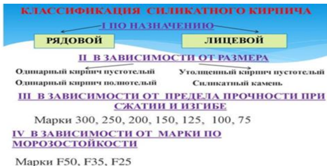
Рис. 2. Классификация силикатного кирпича [7]
